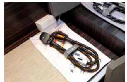
Touraj說電源線與傳遞音樂訊號的線材不同，只傳遞單一頻率訊號，所以不需並用多種導體，設計重點在加強屏蔽、降低干擾。
