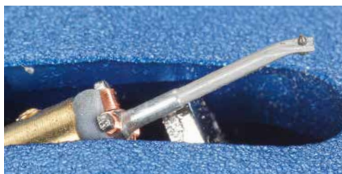
Der zweiteilige Teleskopnadelträger bewegt einen kreuzförmig bewickelten Spulenträger. Der Diamant wurde mittels Lötkegel fixiert.
